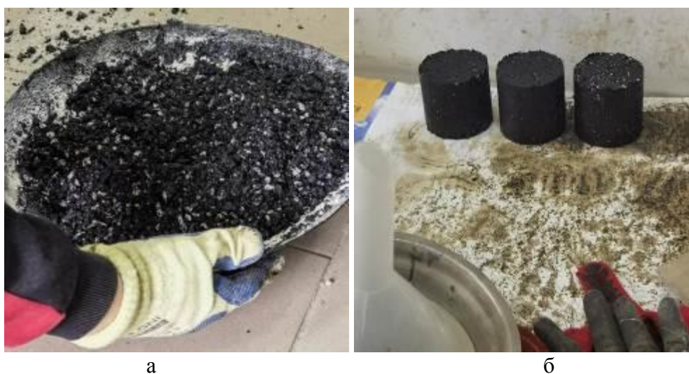
Рис. 1 – Виготовлена асфальтобетонна суміш(а) та зразки для досліджень (б)
