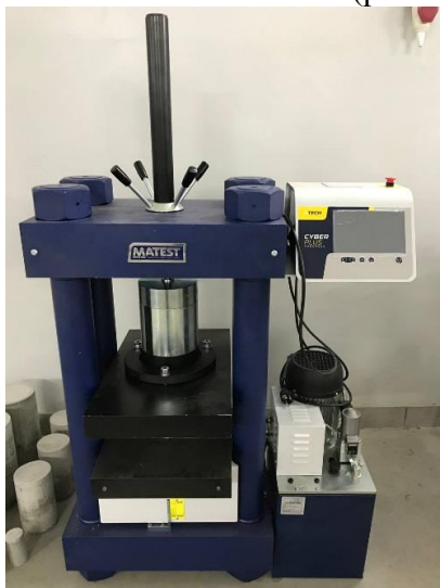
Рис. 1 Випробувальна машина для стискання бетону
