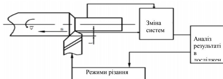
Рисунок 1 – Схема оптимізації процесу точіння
