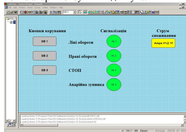
Рисунок 2. Схема керування стендом в програмному середовищі CodeSys
